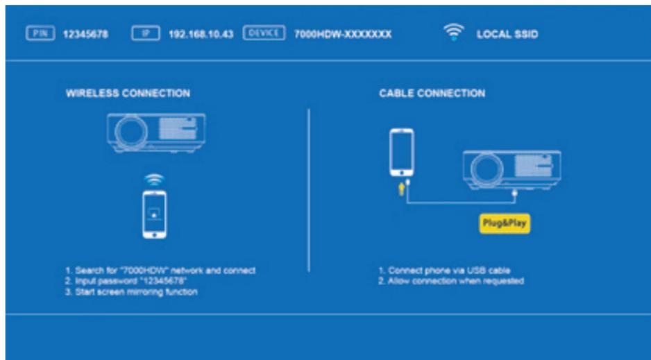
Connettere lo smartphone o tablet alla rete wireless in uso, quindi, attraverso la funzione di duplicazione dello schermo, sarà possibile ottenere la riproduzione del display: essendo quest'ultimo a sviluppo verticale, il riempimento dell'intera area di proiezione si otterrà con la sua rotazione in modalità orizzontale (landscape).
