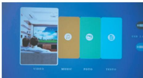
Sulla parte destra della schermata è visibile lo stato di ciascuna delle due porte USB, in azzurro le porte nelle quali è inserito un pendrive, in grigio le porte libere. Con i tasti freccia a destra e freccia a sinistra, su tastierino di controllo o telecomando, è possibile evidenziare il riquadro corrispondente al tipo di file multimediale si desidera riprodurre, quindi confermare con "OK".
