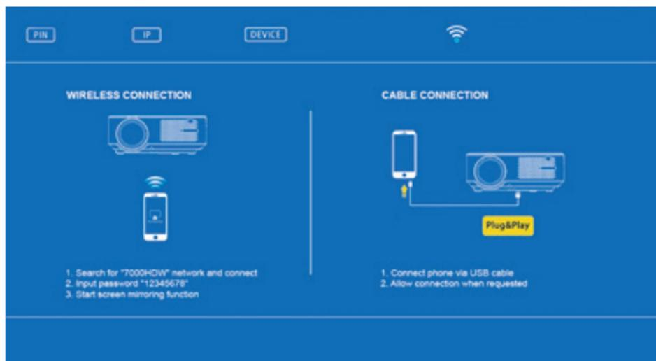
Accedere al menu delle impostazioni dello smartphone o del tablet e, dal sottomenu delle connessioni, connettersi a "7000HDW-XXXXXXX" utilizzando la password: 12345678. Il dispositivo indicherà una connessione priva di accesso a internet, che dovrà essere ignorata.
